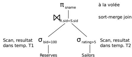
On pousse la sélection sous la jointure (car selection AND). On suppose qu'on a 100 bateaux, 10 notes et distributions uniformes.
