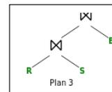
On choisi de faire d'abord une jointure entre R et S, sur l'attribut sid puis jointure du résultat intermédiaire sur bid.
