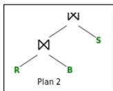
On choisi de faire d'abord une jointure entre R et B, sur l'attribut bid puis jointure du résultat intermédiaire sur sid.
