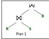
On choisi de faire d'abord une jointure entre R et S (i.e. un produit cartésien car il n'y a pas de condition de jointure entre ces deux tables). Puis la jointure de la table résultante avec B sur les attributs (bid,sid).
